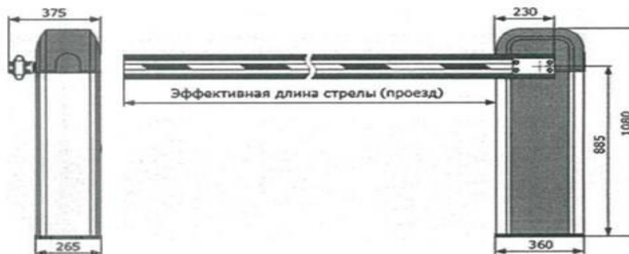
Рис. Размеры шлагбаума (указаны в миллиметрах)
